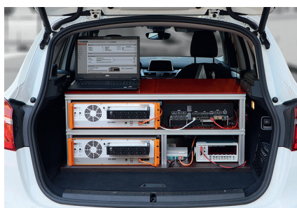
Demo-Setup im Kofferraum: ViGEM Datenlogger mit Wechselspeicher und Peripheriegeräten. © ViGEM
